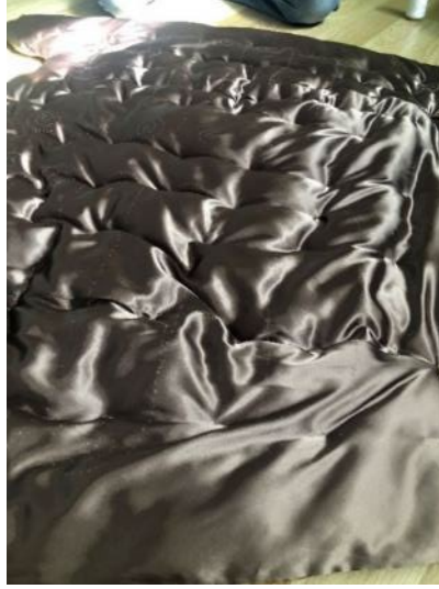
Resim 22. Belirli aralıklarla yüzey üzerinde teyelleme yapılması.
